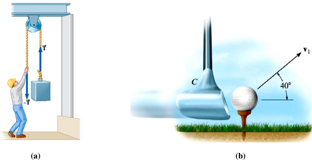
Figura 4.1 (a) La fuerza T aplicada por el hombre al extremo de la cuerda es transmitida al otro lado de la polea y permite subir al bloque, (b) Al aplicar la fuerza a la pelota usando el bate, se cambia la dirección de movimiento de la pelota
